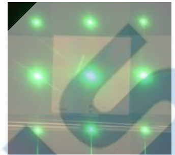
Как видится через световую решетку яркая точка на экране, полученная с помощью лазера.
